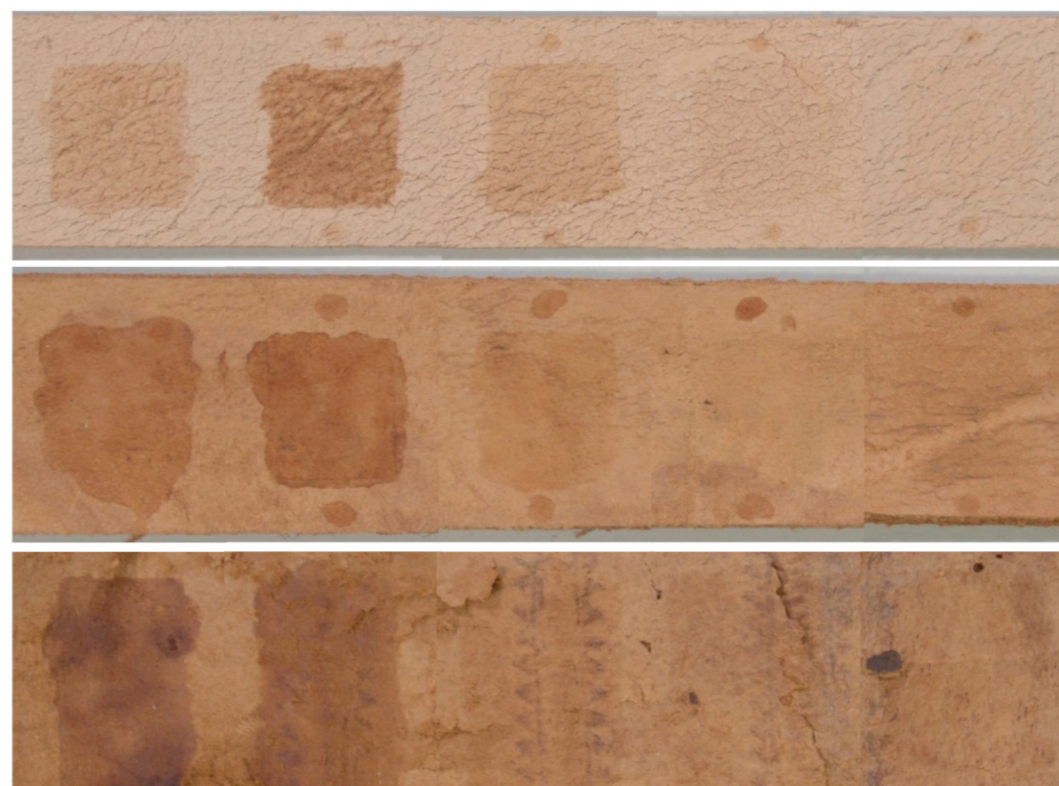
Abb. 2: Verfärbungen an der Referenz (oben) und Testleder 7 (Mitte) und Testleder 6 durch Lösungen von Klucel in Wasser, Methanol, Ethanol, Ethyl-Lactat und 1-Pentanol (von links nach rechts), © Pesch
