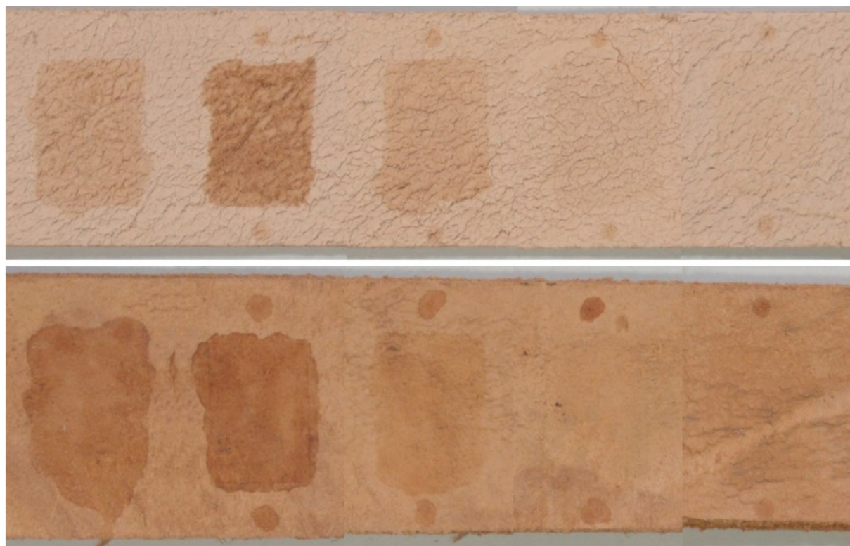
Abb. 1: Verfärbungen an der Referenz (oben) und Testleder 7 durch Lösungen von Klucel in Wasser, Methanol, Ethanol, Ethyl-Lactat und 1-Pentanol (von links nach rechts). Die Referenz stellt ein modernes ungeatertes Leder dar. Die Testleder 1-7 sind unterschiedlich natürlich gealtert, © Pesch
