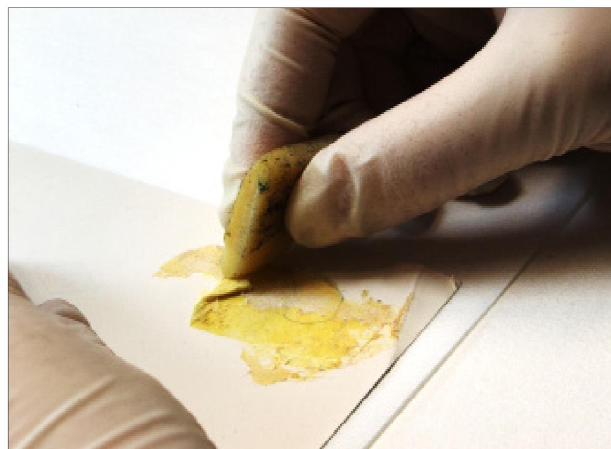
Abb. 2: Die Abnahme von Klebmasse und Träger des doppelseitigen Selbstklebebandes mit einem Kreppradierer, © Zettner
