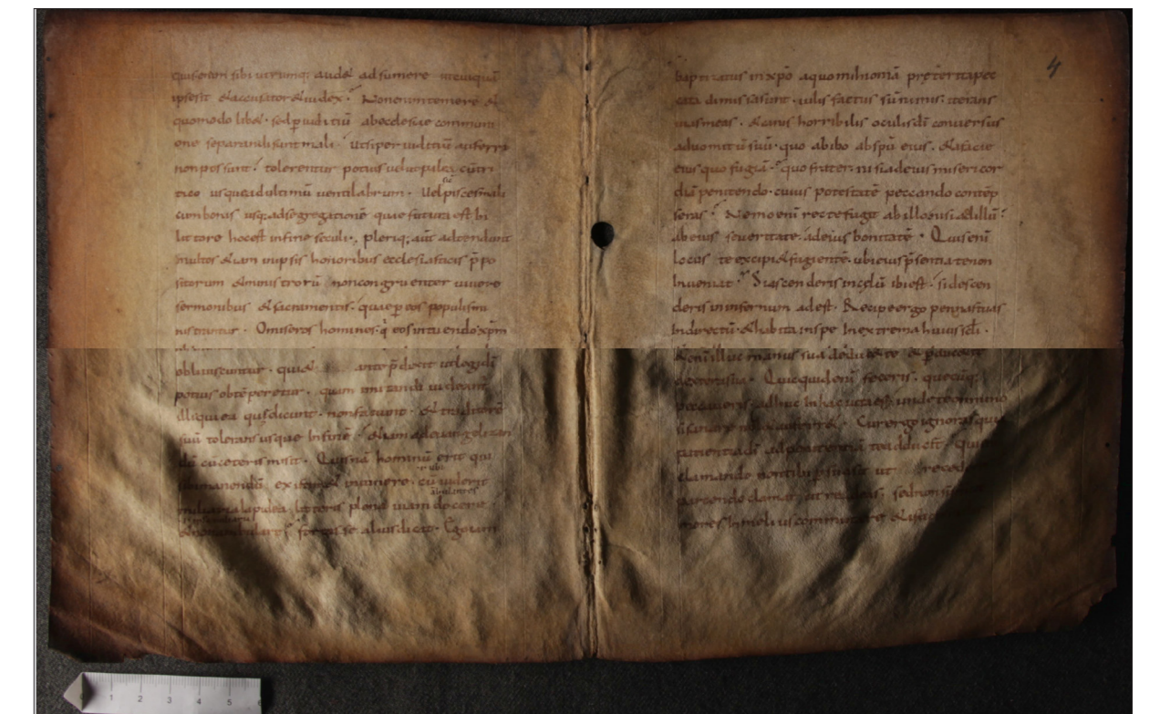
Abb. 3: Vergleichsaufnahme einer konditionierten und geglätteten Pergamentseite im Vorzustand (unten) und im Nachzustand (oben).
