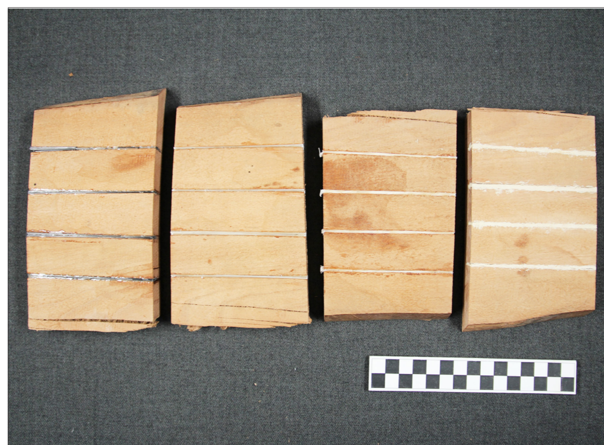
Abb. 2: Probekörper mit eingebrachten Füllmaterialien. Von links nach rechts: Carbonstäbe, Glasfaserstäbe, Heftzwirn, Bärlappsporenkitt, © Linden
