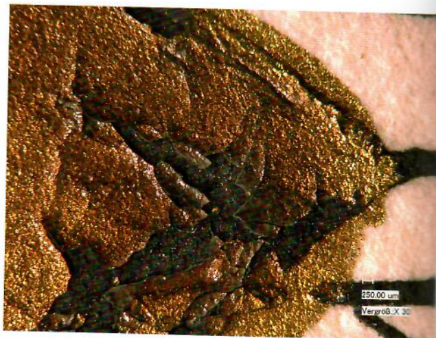
Abb. 3 Michael Buthe: o.T. (España 13.). 1978.094. Mikroskopaufnahme. Die Metallfarbe ist verbräunt und durch die ausgeprägte Rissbildung sind bereits lose Farbschichtschollen entstanden. Eine Maßeinheit: 0,25 mm.
