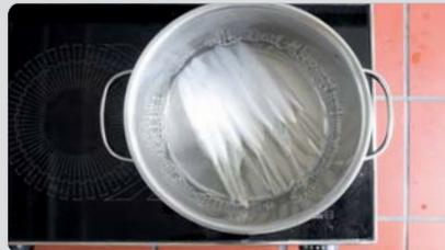
Die Federn werden vor dem partiellen Färben entschlichtet, um Verschmutzungen, Rückstände und Federfett, welche die Aufnahme des Farbstoffs verhindern könnten, zu entfernen. Die Entschlichtung erfolgt für 30 min in einer Tensidlösung mit Tinovetin JUN<sup>®</sup> (0,5g/l) bei 60 °C.
