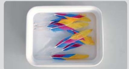
Danach erfolgt die Nachwäsche des Färbeguts nach Angaben des Herstellers (HORNIG 2005, S. 40). Abweichend vom empfohlenen Tensid Tinegal W<sup>®</sup> wurde Tinovetin JUN<sup>®</sup> verwendet. 5 min kalt spülen; 3 min bei 30 °C mit 2g/l Tinovetin JUN<sup>®</sup>; 5 min bei 50 °C mit 2g/l Tinovetin JUN<sup>®</sup>; kalt spülen.
