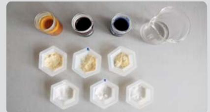
Die Stammlösungen werden im Verhältnis 1:100 in entmin. Wasser angesetzt. In 30 ml Farbstoff werden 5% Harnstoff und 5% Prisulon DCA 130 (Verdickungsmittel) gegeben und unter Rühren aufgelöst. Das Verdickungsmittel quillt für 40 min. Danach wird die Farbstoffpaste mit 10% -Zitronensäure auf den pH-Wert 4,5 eingestellt (HORNIG 2005, S. 45-51).
