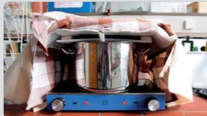
Die Federn im Rahmen werden für 60 min über einem Kochtopf mit 60 °C warmen entmineralisiertem Wasser fixiert. Über dem Rahmen wurde mit Abstandhaltern versehen ein weiterer Rahmen mit Löschkarton gelegt. Der Kochtopf und die Aufbauten wurden mit Handtüchern ummantelt.
