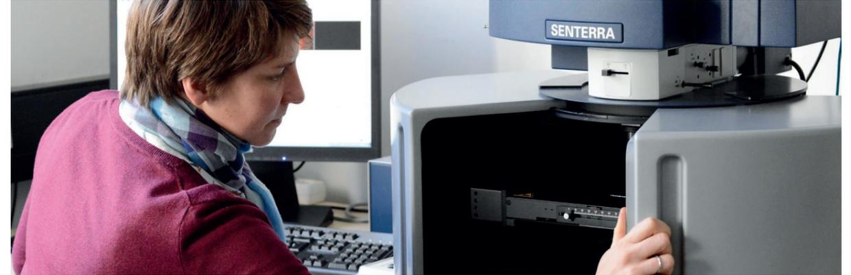
Raman-Spektroskopie mit gekoppeltem Mikroskop
