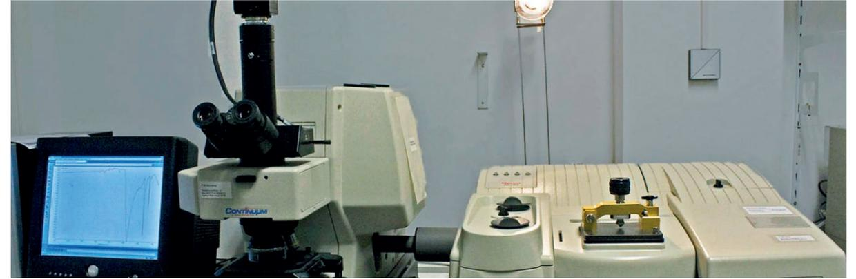
FTIR-Spektrometer mit Mikroskop
