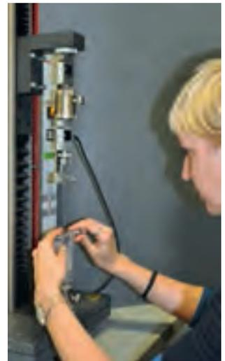
Zwick-Zugprüfmaschine, hier beim Einsatz für die Messung der Zugfestigkeit von Einzelfadenverklebungen (Christine Baltscheid)
