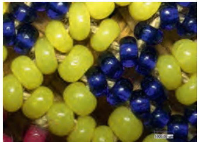
Auflichtmikroskopische Untersuchung von Glasperlen im Rahmen eines Moduls zu materialkombinierten Objekten
