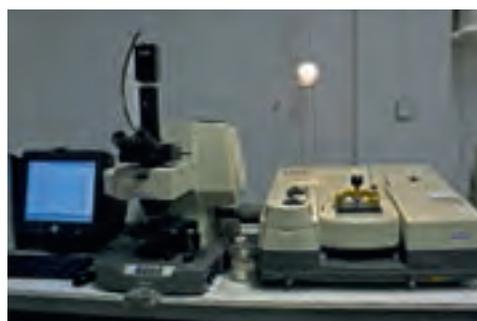
FTIR-Spektrometer mit Mikroskop
