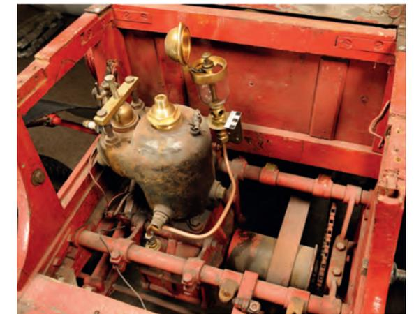
Wassergekühlter Einzylinder-Viertaktmotor mit Antriebswelle.
