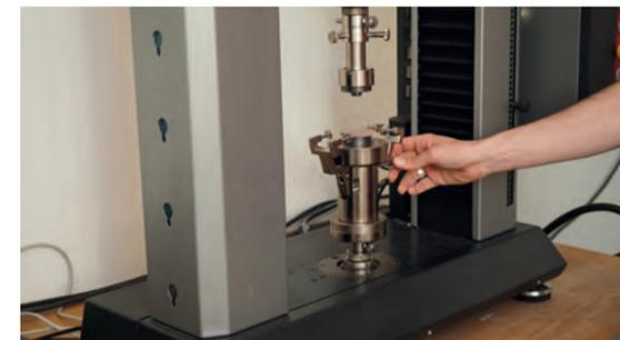
Biaxiale Biegezugfestigkeitsmessung an den Bohrkernscheiben.
