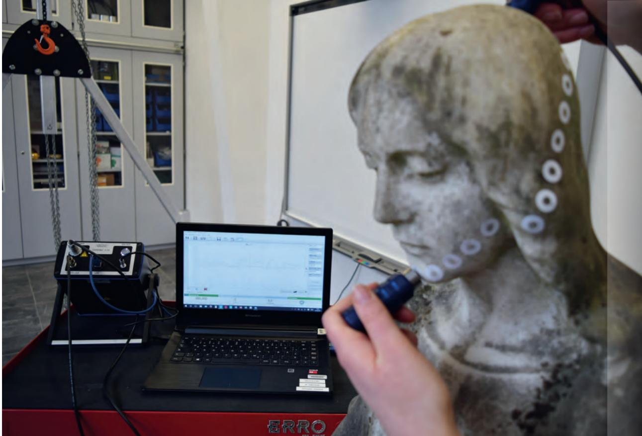
Schadensdiagnose mittels Ultraschall-Tomographie.
