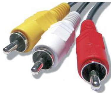
Bild 2.2.4-1 Stecker für Videoverbindung (gelb) mit zusätzlichen Audiosteckern (rot + weiß)
