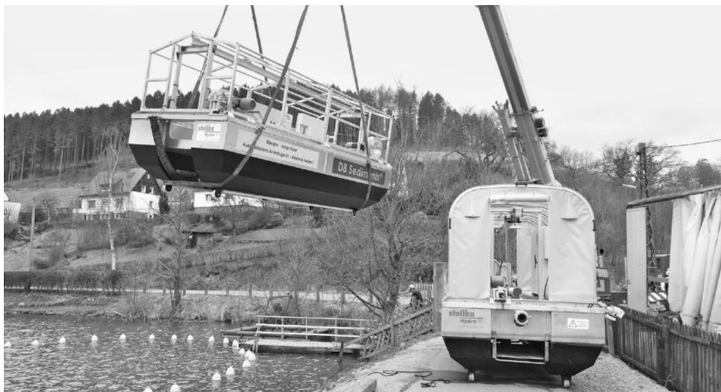
**Bild 2:** Gerätebeispiel für eine vollautomatische Sedimentverlagerung (Quelle: DB Sediments)
