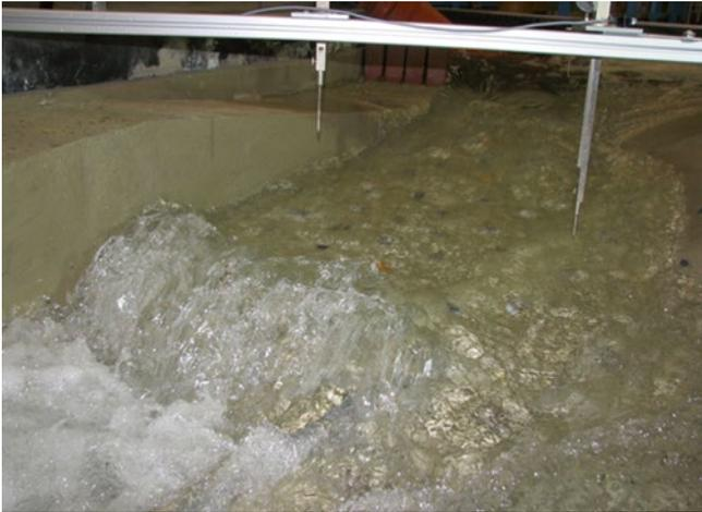
**Bild 3:** Anströmung des Trennbauwerks bei einem Zufluss von ca. 31 m<sup>3</sup>/s mit Blick gegen die Fließrichtung
