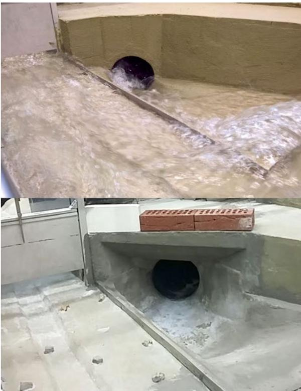
**Bild 4:** Ursprünglich geplanter und verbesserter Grundriss des Einlaufbauwerks
