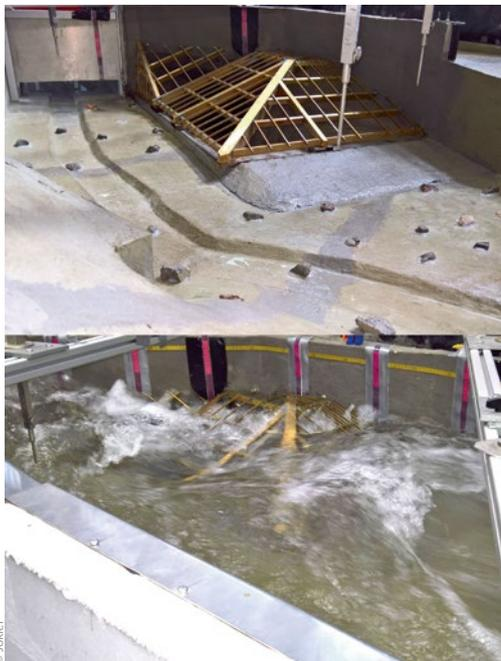
**Bild 5:** Einlaufbauwerk mit aufgesetztem Rechen sowie Wechselsprung und stehende Wellen in Zustrom zum Trennbauwerk
