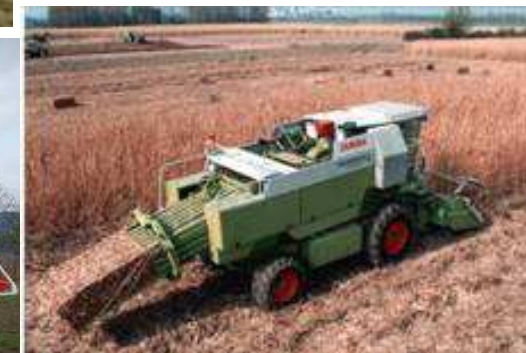
Innovative Erntetechnik: „Tree-Eater“, Schnittholzsammler
