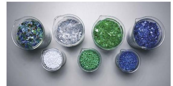
Hier farblich sortiert: Die PET-Recyclingrohstoffe, sogenannte *Flake*, werden aus PET-Flaschen gemahlen (oben). Das Granulat (unten) ist das Ergebnis des chemischen Verfahrens „Von-der-Flasche-zur-Flasche“.
