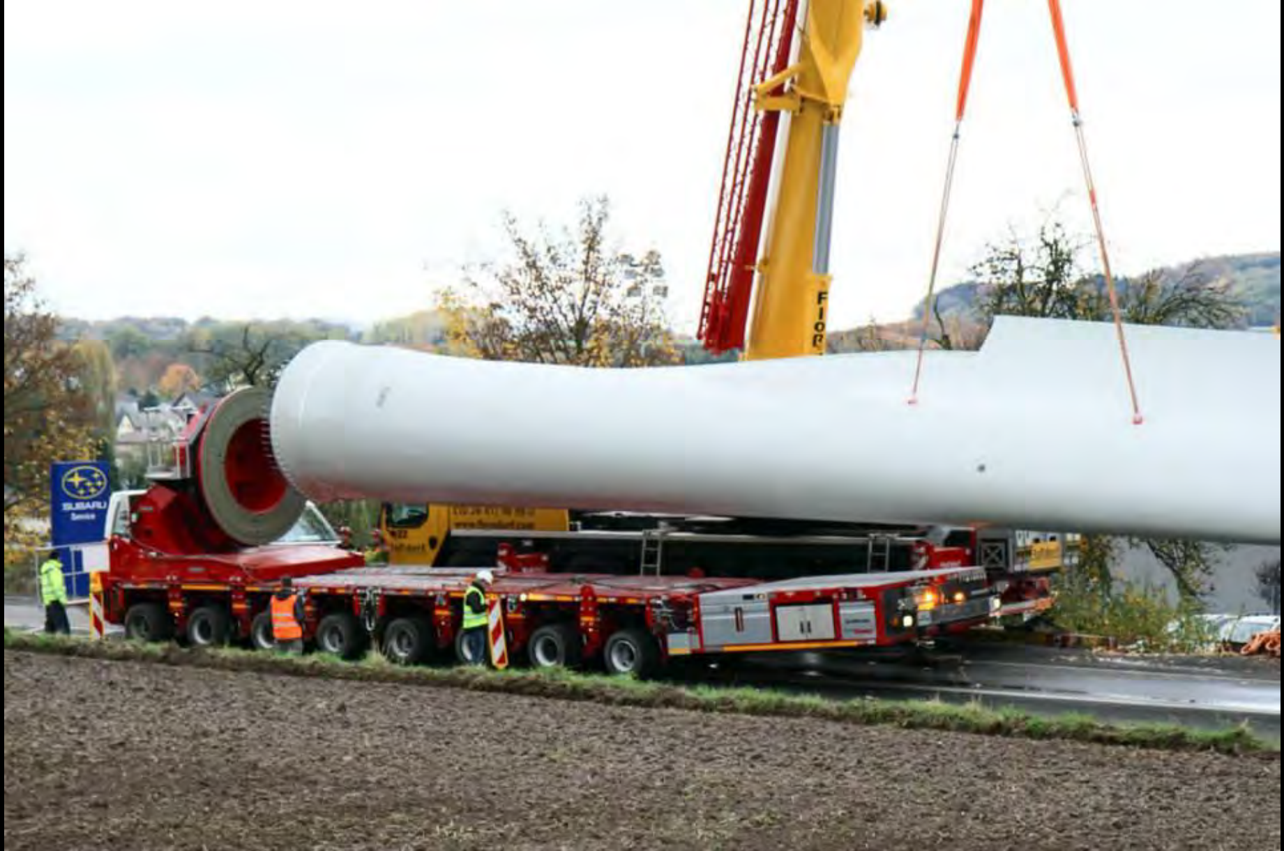
Blatttransport: selbstfahrende Spezial-Transportvorrichtung kann das Blatt in alle Richtungen schwenken
