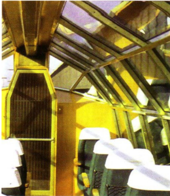
1. Sonnenschutzscheibe auf Basis Au verglast im 'Rheingold', Fa. Heraeus/DETAG
