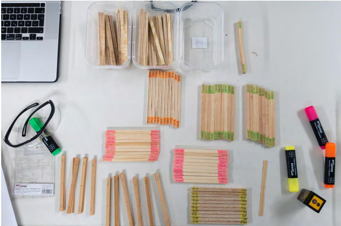
In Rahmen einer Masterveranstaltung zum Werkstoff Sperrholz werden Probekörper für Bruchtests vorbereitet. (Bild: © TH Köln - CICS - Andreas Krupa 2021)
