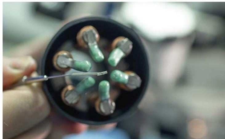
Das mit einer speziellen Legierung angefertigte Schneidewerkzeug aus Stahl ist einen Millimeter hoch und hat fünf Millimeter Durchmesser. Angetrieben wird es über ein externes Magnetfeld.
