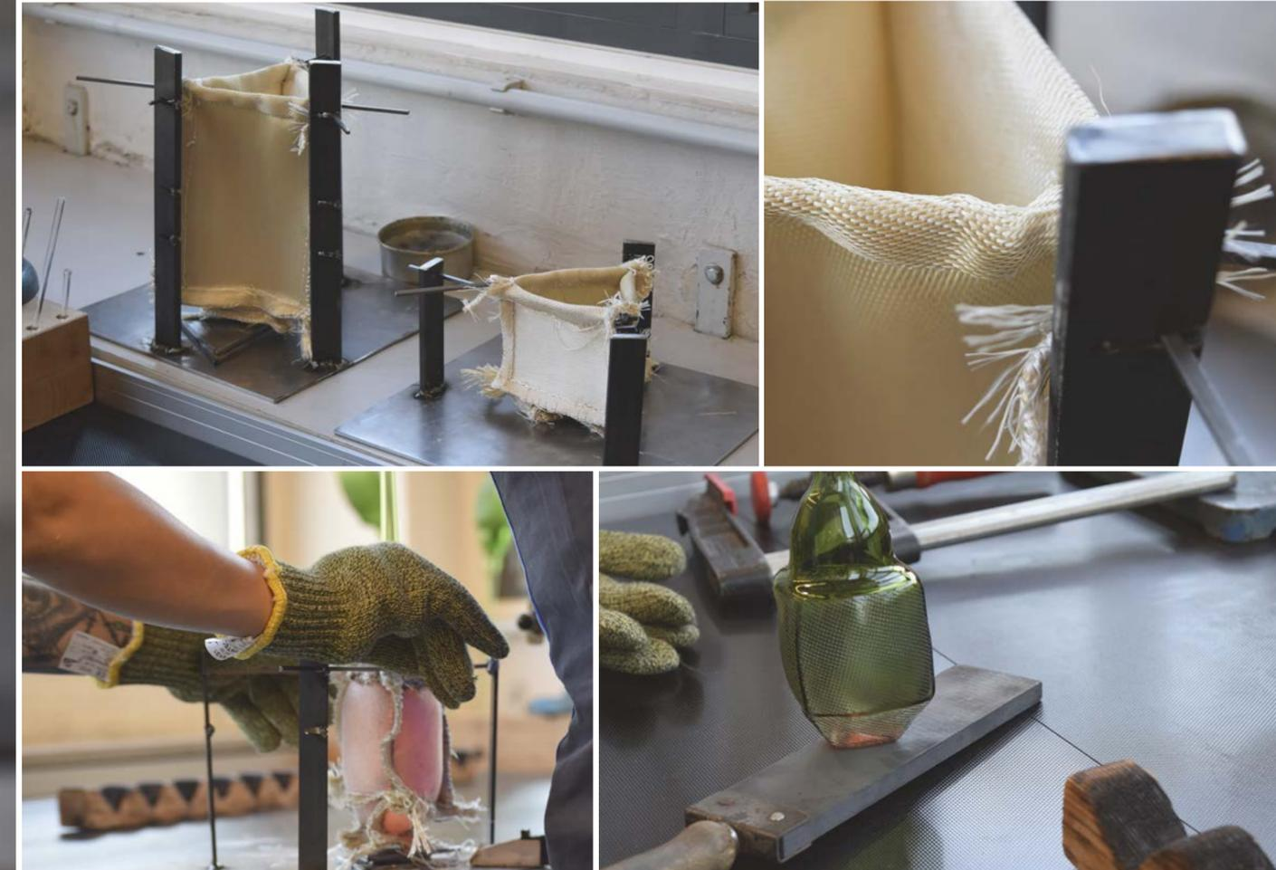
(oben) Als Einblasform verwendet Naja Schulz ein zu einer Dreiecksform genähtes Textil aus Siliziumgewebe, das freischwebend installiert ist. Das flüssige Glas nimmt die Textur des Stoffes an, aber mit individuellen Unterschieden, die durch den Faltenwurf des Stoffes und das Ausdehnungsverhalten des honigartigen, heißen Glases entstehen (unten).
