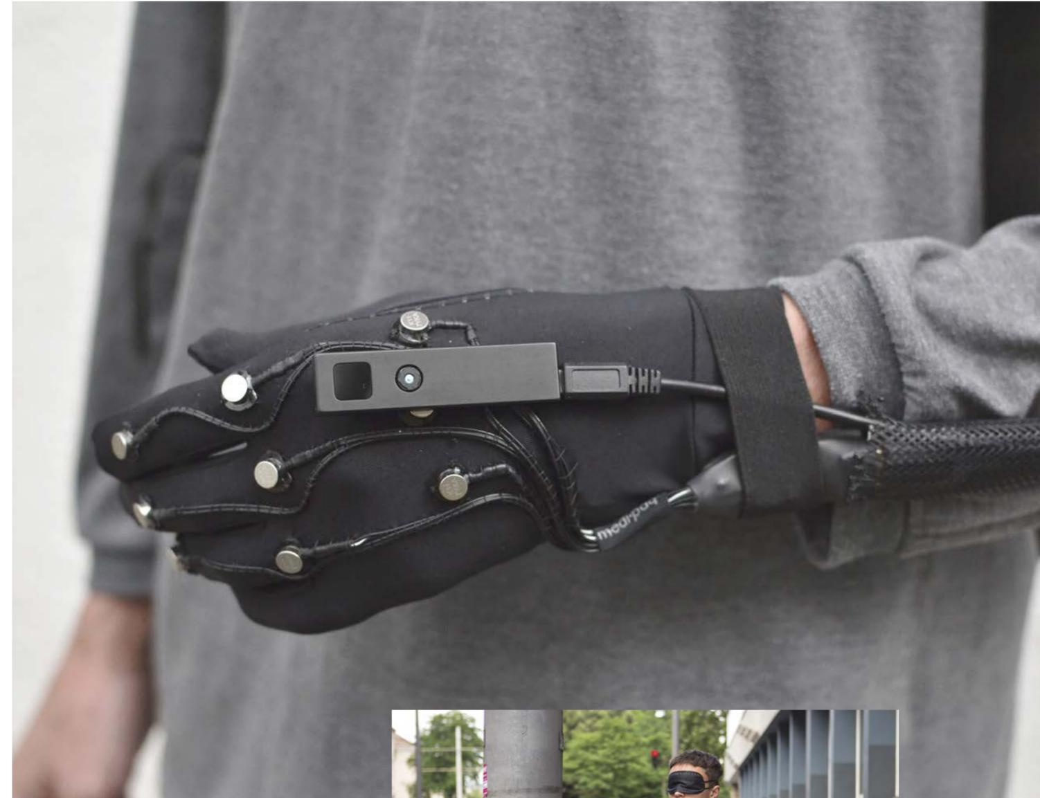
Eine Tiefenkamera visualisiert in einem Winkel von 45 Grad alle Objekte in einer Reichweite von bis zu viereinhalb Metern. Ausgelegt ist der Prototyp aber auch für Smartphones, die über eine Tiefenkamera-Sensorik verfügen. Die Produktionskosten des Handschuhs liegen dadurch bei unter 100 Euro.
