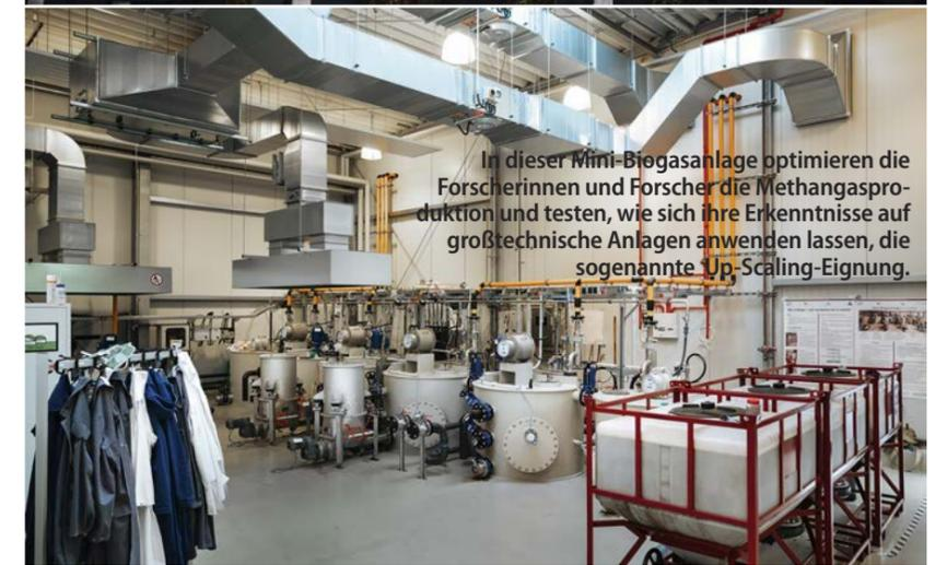
In dieser Mini-Biogasanlage optimieren die Forscherinnen und Forscher die Methangasproduktion und testen, wie sich ihre Erkenntnisse auf großtechnische Anlagen anwenden lassen, die sogenannte Up-Scaling-Eignung.
