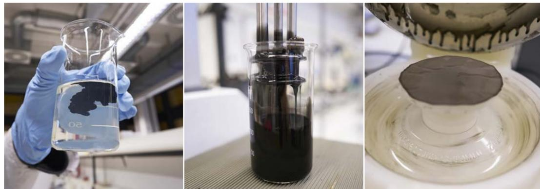
(v. l.) Die Carbon Nanotubes werden in einer Polymerlösung hochfein verteilt. Diese Dispersion wird anschließend in einem Spin-Coater zu einer Membran aufgeschleudert, die hauchzart und gerade mal 25 bis 30 Mikrometer dünn ist.
