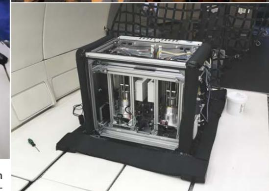
(re.) Die beiden 3D-Prototypen müssen stoßsicher eingepackt und am Boden verschraubt werden.
