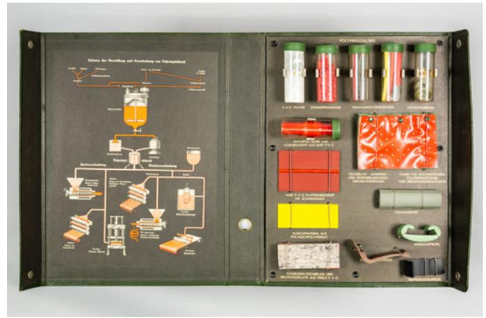
Abb. 3: Dieser Band der „Kunststoff-Schule“ aus dem Hans Pickardt Verlag zeigt die Herstellung, Verarbeitung und Erzeugnisse aus Polyvinylchlorid (PVC). Foto: Andreas Krupa.
