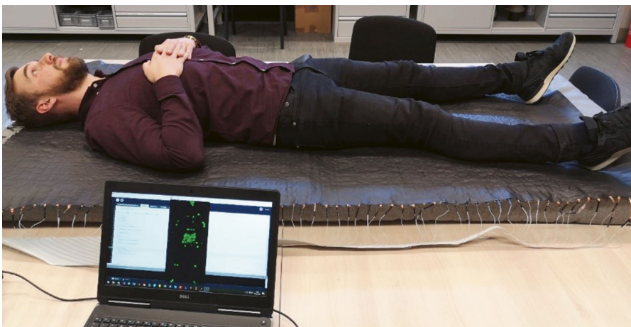
Tests mit dem Prototyp der im Projekt entwickelten Anti-Dekubitus-Matte haben gezeigt, dass diese Druckstellen auf der Liegefläche messen und dadurch mögliche Dekubitus-Gefahrenbereiche ermitteln kann.
