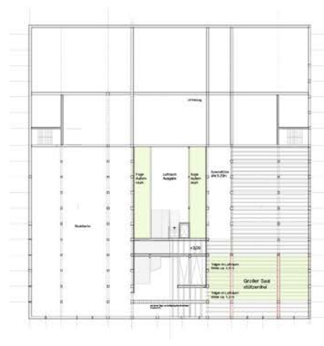
Konzept Tragwerk Decke über OGs +9,50 / + 13.00
