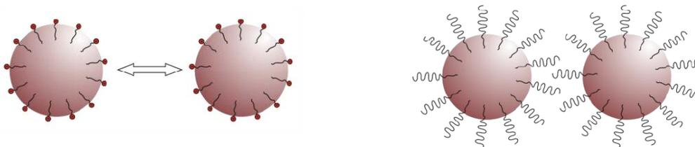
Abbildung 1 **Elektrostatische (links) und sterische (rechts) Stabilisierung.**
