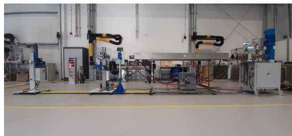
Die Extrusionslinie des Polymer-Labors. (v.l.n.r.: Wickler, Abzug, Kühlbecken, Extruder)
