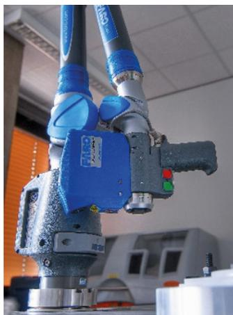
Optisches Messsystem zur Vermessung von Bauteilen (Foto: Frank Reipen / TH Köln)
