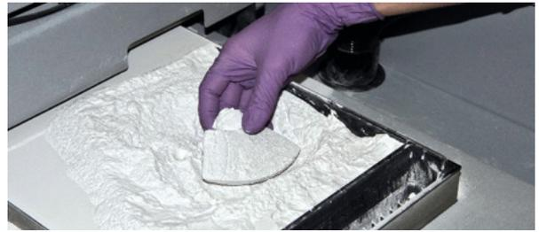
Herstellung von 3D-Druck Bauteilen (Bild: Frank Reipen/TH Köln)
