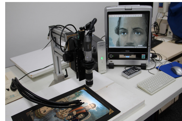
Makroskopische Untersuchung einer Chromolithografie mit dem Keyence Videomikroskop © A. Pataki-Hundt
