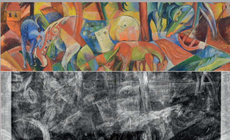
Abb. 9: Wolfgang Beltracchi: ROTES BILD MIT PFERDEN, angeblich von Heinrich Campendonk gemalt: Die 50 RFA-Messungen werden dargestellt durch weiße und schwarze Punkte. Nur in den weiß markierten Bereichen wurde Titan detektiert. Sehr wahrscheinlich befindet sich auch in den schwarz markierten Bereichen Titan in der Grundierung, das aufgrund von Schichtenüberlagerungen nicht nachgewiesen werden kann.
