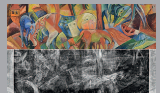
Abb. 8: Wolfgang Beltracchi: ROTEN BILD MIT PFERDEN, angeblich von Heinrich Campendonk gemalt: Die digitale Radiografie zeigt Reste einer früheren Darstellung auf dem Bildträger.
