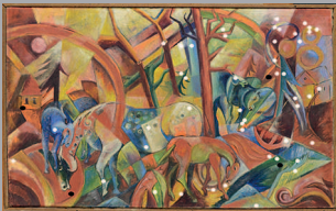
Abb. 9: Wolfgang Beltracchi: ROTES BILD MIT PFERDEN, angeblich von Heinrich Campendonk gemalt: Die 50 RFA-Messungen werden dargestellt durch weiße und schwarze Punkte. Nur in den weiß markierten Bereichen wurde Titan detektiert. Sehr wahrscheinlich befindet sich auch in den schwarz markierten Bereichen Titan in der Grundierung, das aufgrund von Schichtenüberlagerungen nicht nachgewiesen werden kann.
