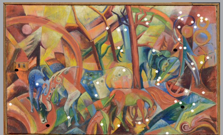
Abb. 9: Wolfgang Beltracchi: ROTES BILD MIT PFERDEN, angeblich von Heinrich Campendonk gemalt: Die 50 RFA-Messungen werden dargestellt durch weiße und schwarze Punkte. Nur in den weiß markierten Bereichen wurde Titan detektiert. Sehr wahrscheinlich befindet sich auch in den schwarz markierten Bereichen Titan in der Grundierung, das aufgrund von Schichtenüberlagerungen nicht nachgewiesen werden kann.
